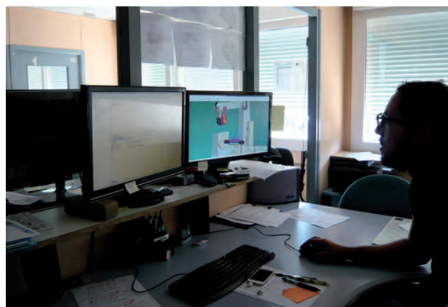
Les opérations de programmation se font intégralement sur un poste déporté afin de maximiser le temps de production.
