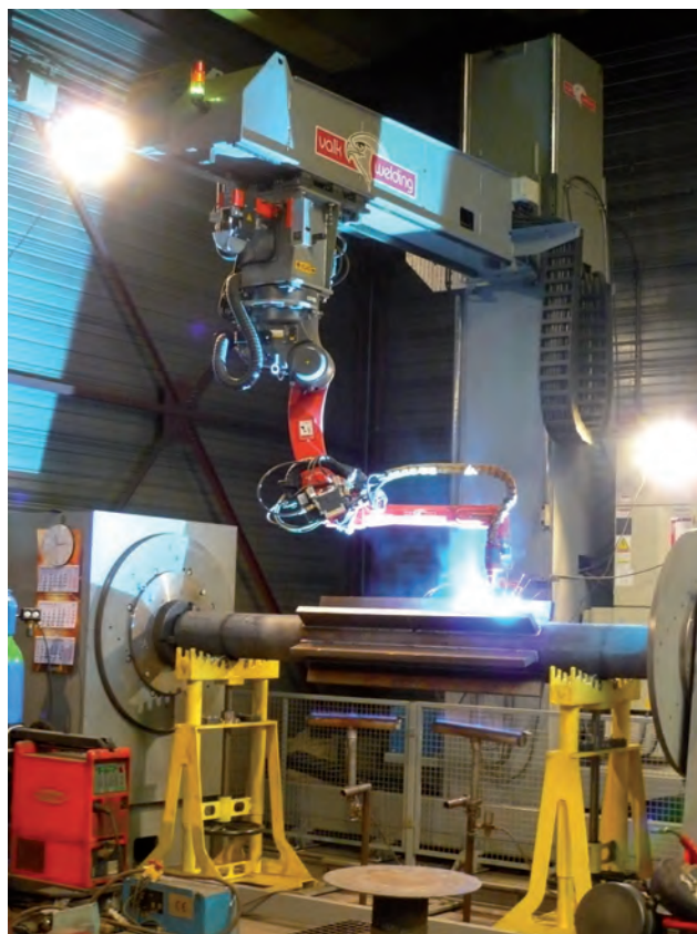
Le robot de soudage acquis par Defametal permet d'assembler des pièces dont le diamètre peut atteindre 3 m et la longueur 10 m.
